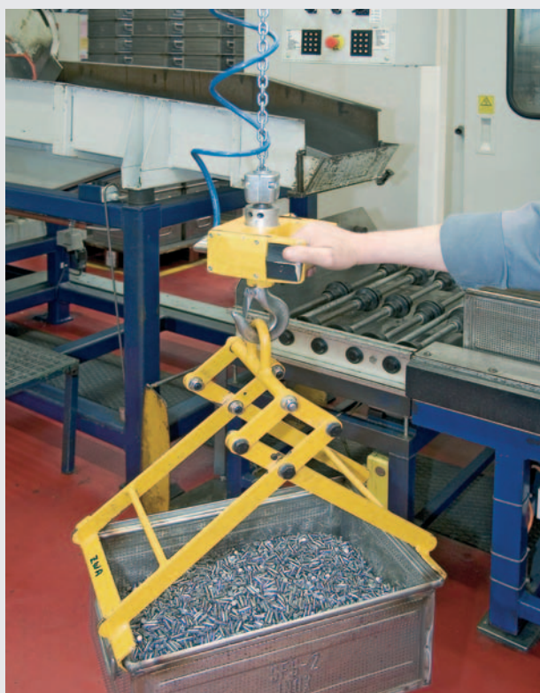
→ Telfer utrustad med Handy enhandsmanövrering med gripverktyg för metallback.
