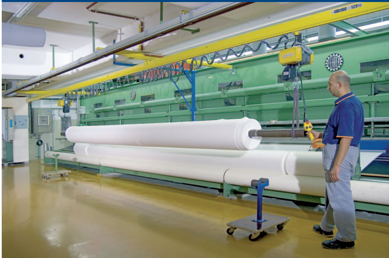
→ Synkroniserade telfrar för lyft av rullar.
